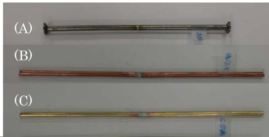
図2 はんだ接合した丸棒試験片 (φ4の場合) (A) 軟鋼 (くぎ)、(B) 純銅、(C) 黄銅
