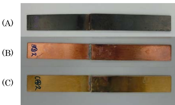
図4 はんだ接合した板状試験片 (20mm×20mmの場合) (A) 軟鋼、(B) 純銅、(C) 黄銅
