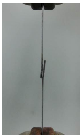
図 12 接合幅 10mm、接合長さ 20mm の試験片 (軟鋼) を引張破断後側面から見た様子
