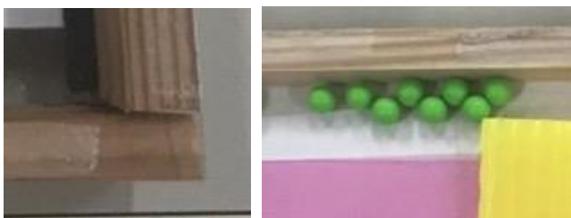
図4 不安定な接合部(左)と両面テープに貼りつく樹脂製球状弾丸(右)
