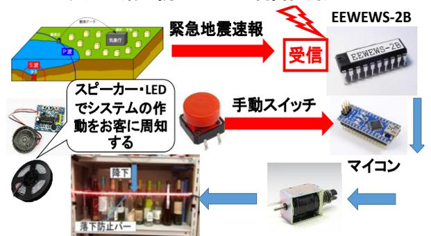
図4 緊急地震速報と連動した地震対策装置
