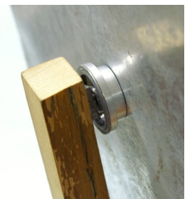
図3 軸受け部を拡大した様子
